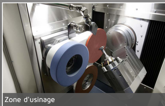
Changement rapide des outils manuellement
