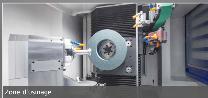
2 bandes abrasives pivotantes
